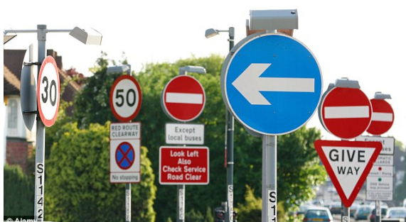
Σχήμα 6.6 Οπτική ρύπανση & δημιουργία σύγχυσης στους οδηγούς από λανθασμένη ή μη ισχύουσα σήμανση: Παράδειγμα από το Ηνωμένο Βασίλειο
