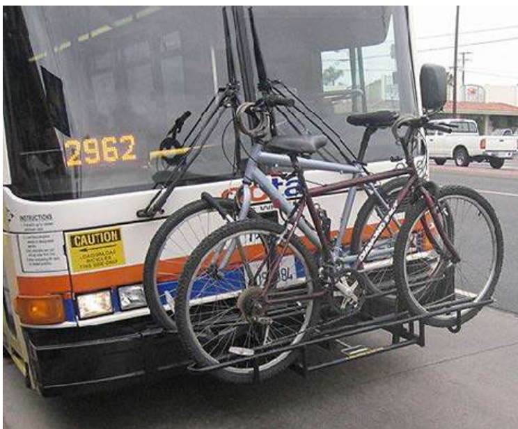
Σχήμα 9.16 Παράδειγμα λεωφορείου ειδικά εξοπλισμένου για τη μεταφορά ποδηλάτων
